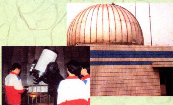
学校天文馆，内设美国加利福尼亚州 meade (米勒) 公司生产的 16 英寸施米特塞格林望远镜， 放大倍率可达 300 多倍，可用于科普和天文观测
