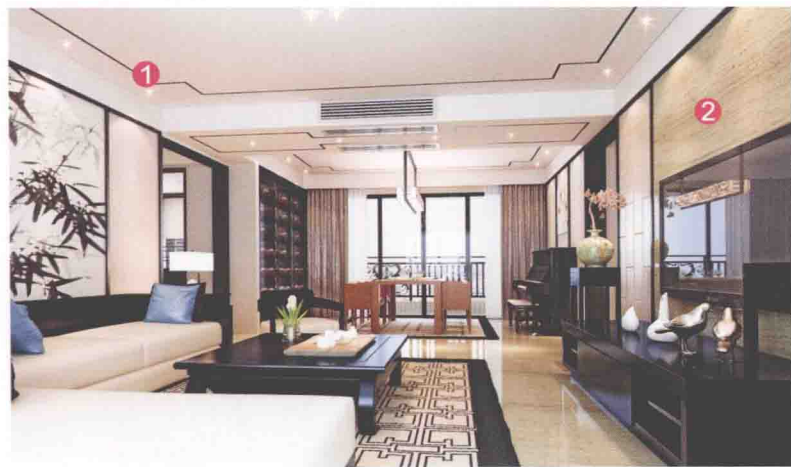
① 石膏板造型勾黑缝 ② 洞石
