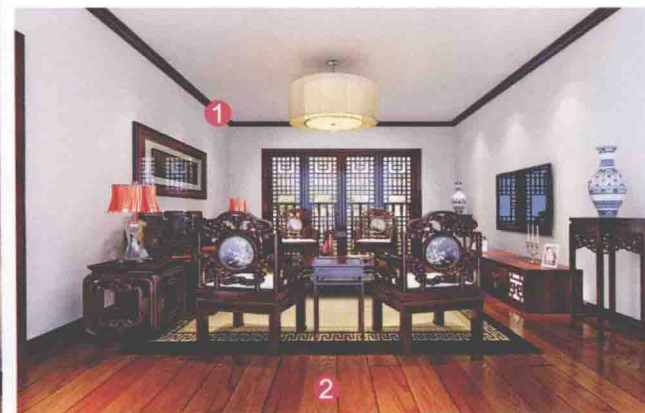
① 木质顶角线 ② 橡木实木地板
