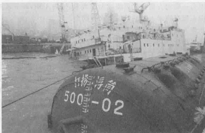
图 1-3 500 t 打捞浮筒照片
