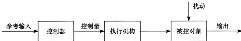
图 1.1 开环控制方式的原理框图
