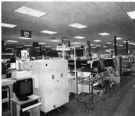
图 1-3 某电子产品生产企业的自动化焊接生产线
