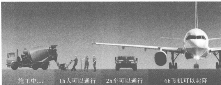
图 1.4 美国洛杉矶机场采用无机聚合物胶凝材料快速修补的效果示意图
