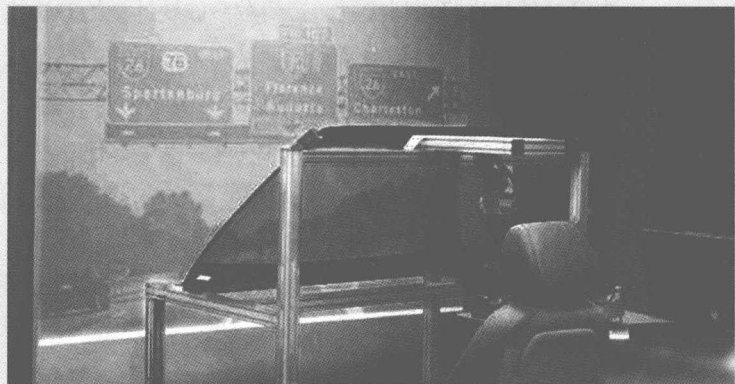
图1-7 驾驶员眼动规律实验装置
