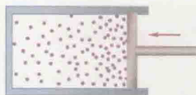
图 12-4 压缩气体时活塞附近分子密度大,压强也大
