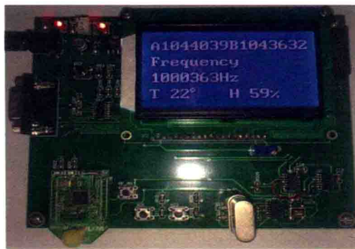
图7 新开发的基于石英晶体微天平测试系统
