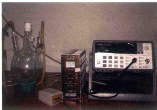
图6 简化功能的QCM测试系统及实验室研究装置
