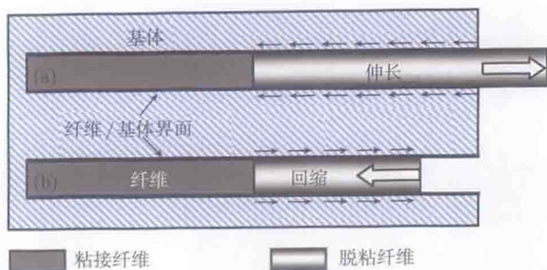
图 5.53 纤维/基体脱粘界面上的摩擦滑移示意图, 小箭头代表摩擦力, 大箭头代表脱粘纤维的伸长过程 (a) 和回缩过程 (b)
