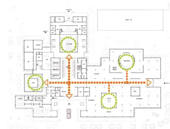
统分结合的思想不同区域可以独立使用 ESPACIOS DIFERENTES SE UTILIZAN INDEPENDIENTEMENTE CON LA COMBINACIÓN DE CENTRALIZACIÓN Y DESCENTRALIZACIÓN DIFFERENT SPACES CAN BE USED INDEPENDENTLY THROUGH COMBINATION OF CENTRALIZATION AND DECENTRALIZATION
