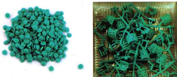
图7 左图为铸模蜡, 呈颗粒状; 右图是已经浇铸了的铸模蜡
