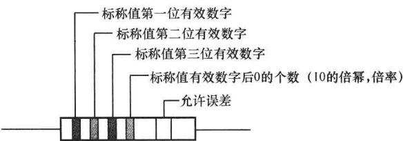
图 1-3 三位有效数字阻值的色环表示法
