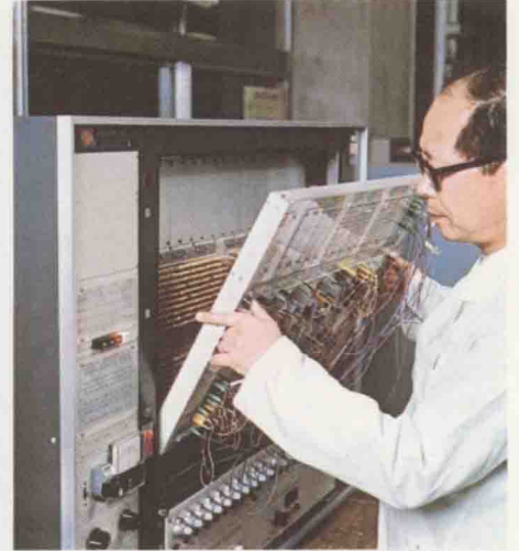
慶応義塾大学工学部計算センター アナログ計算機 左: 卓上アナログ計算機ALS-260 型 右: パッチボードをとりつけているところ
