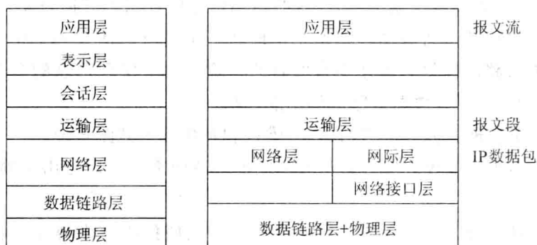
图 1.3 OSI 和 TCP/IP 参考模型的对比
