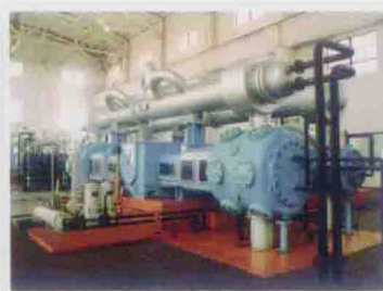
6000m³/h 系列氧压缩机 6000m³/h Series Oxygen Compressor
