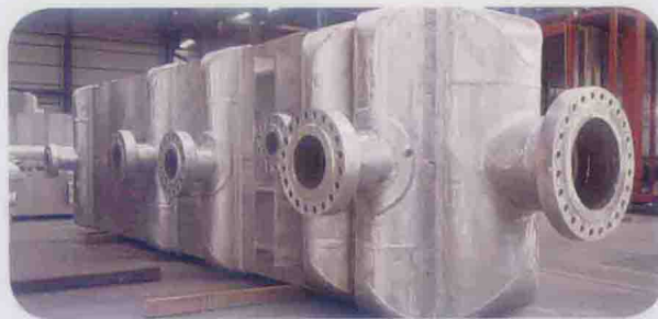
出口美国 9.0MPa 高压换热器
