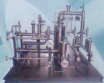
LNG 加气站泵池撬
