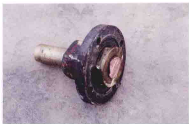
图 1-4 锯割下来的套管引线座
