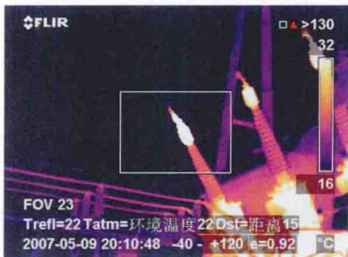
图1-2 负荷电流310A时A相套管将军帽处红外热像图
