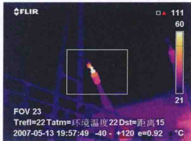
图1-3 负荷电流280A时A相套管将军帽处红外热像图
