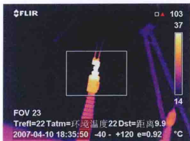
图1-1 负荷电流271A时A相套管将军帽处红外热像图
