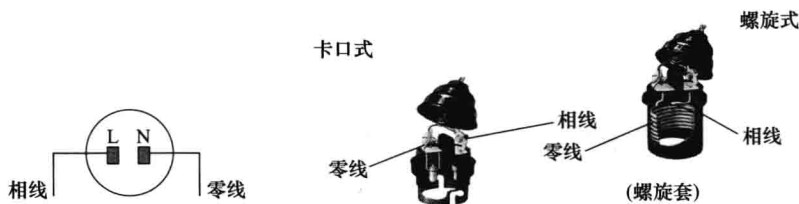
图 1-2 灯座的接线
