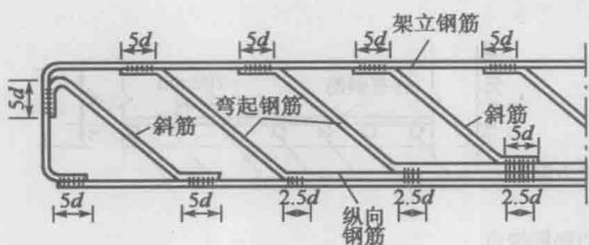
图 1-5 焊接钢筋骨架的标注
