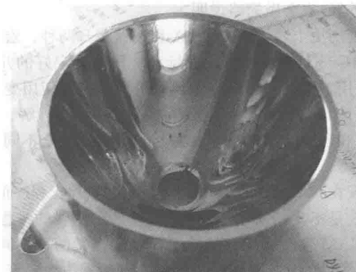
图 1-3 用数控宏程序加工的旋转抛物面
