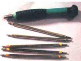
拆卸手机最基本的工具是六角与十字螺丝刀。一套多型号的手机专用螺丝刀可满足大多数手机拆卸的需要。
