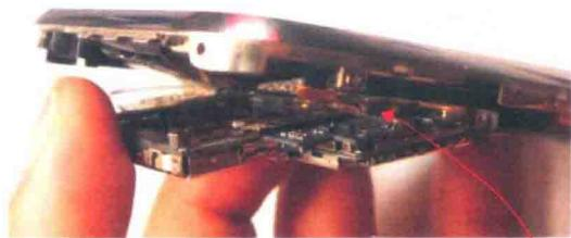
电路板下面可能有多个连接器连接，注意不要损坏连接器。
