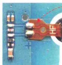
有些装配件直接焊接在电路板上，注意不要焊接错误！
