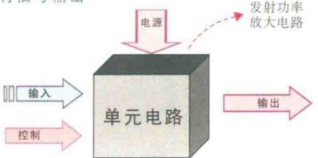
④ 有工作电源，无信号输入，有控制输入，有信号输出
