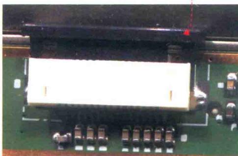
装配主电路板与子电路板之间的连接时，连接器排线一定要装配到位。
