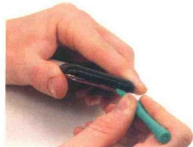
除螺丝刀外，镊子、塑料撬片与撬棒也是常用的工具。在拆卸某些手机时，还可能用到一些独特的器具。例如，在拆卸iPhone手机时，一个合适尺寸的塑料吸盘会非常有用。
