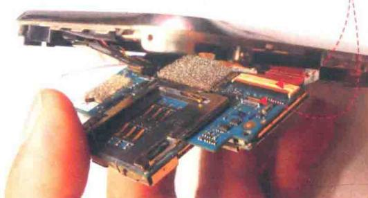
拆开机器后，应注意观察机器内有无氧化、液体进入现象。
