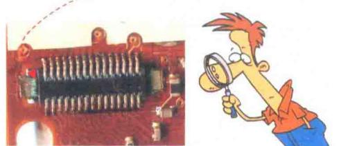
分离电路之间的连接时，注意不要损坏电路连接器的卡口。
