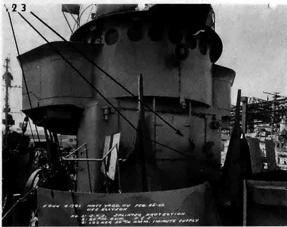
▲ “本森”号舰桥，可以看到两个安装防空炮的防盾以及后面被帆布盖着的20毫米厄利孔机关炮。
