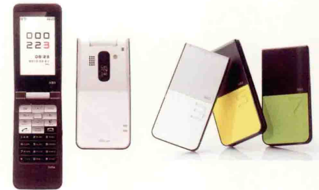
图1-2 这款手机由知名设计师岩崎一郎设计，京瓷制造。手机有一个2.8英寸的LCD屏，内置了GPS和电子钱包功能，手机背面是一个摄像头和一小块电子时钟。手机有白绿黄三种颜色，每个颜色有一个对应的数字刻在手机前盖上。
