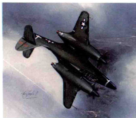
↑ 麦克唐纳公司的工程师用最新的飞机技术设计了双发的 XP-67 飞机，这些新技术包括一种先进的机体设计，并配备了一对不幸的、未经验证的、带涡轮增压的康特蒙特公司的 I-1430 发动机。该发动机被证明是设计的薄弱环节。
