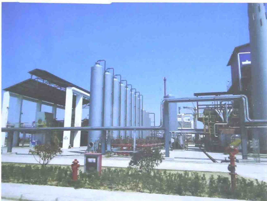
图 7 四川亚联公司每小时 9000 立方米变压吸附提纯氢气装置 (毛宗强提供)
