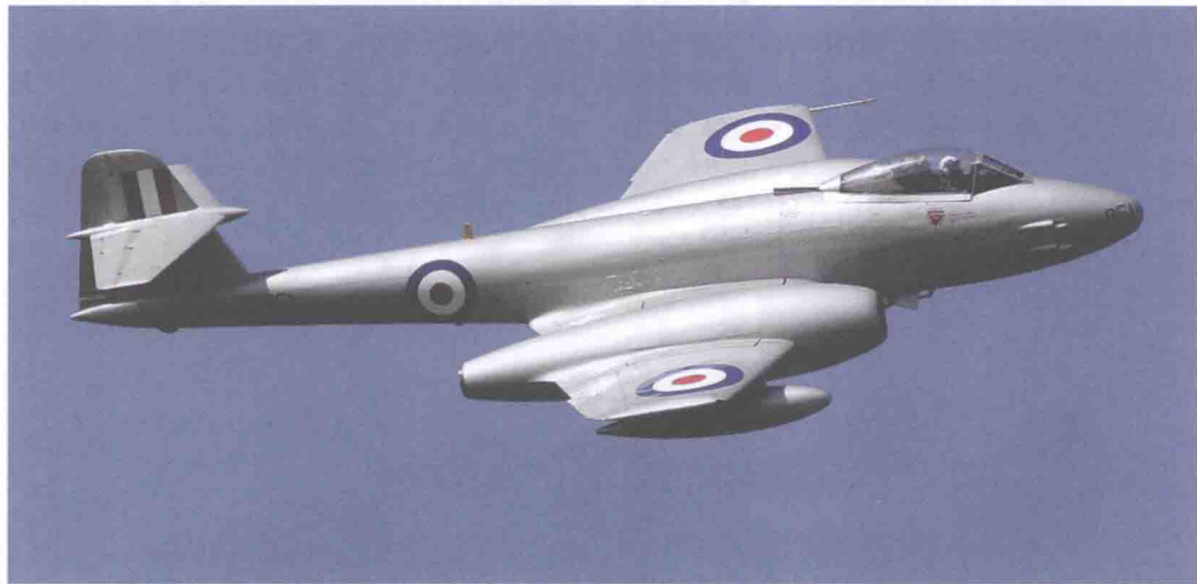
▲ 图为“流星”F.8 战斗机。这个型号的发动机舱跟上图相比“苗条”不少, 但气动布局仍是二战风格, 注意看尾翼单元已经发生变化。高置水平尾翼布局在早期飞机, 特别是机动性能不好的飞机上用缺点并不明显, 英国人死抱着这条定律不肯放手, 直到“闪电”截击机打破了英国人的迷信。
