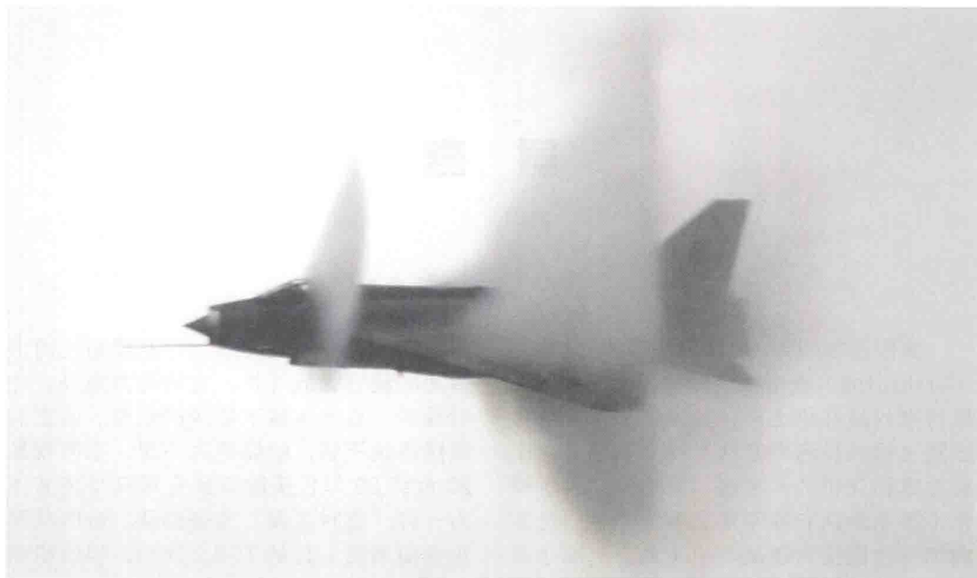
▲“闪电”飞机低空飞行时机头和机身中间出现的激波。在低空，水汽条件合适的情况下就会出现，不一定是超音速状态。
