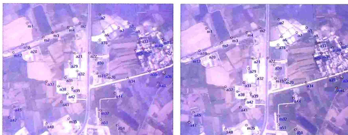
图 7.12 基于三视图的匹配角点特征提取结果
