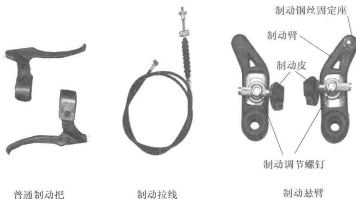
图 2-6 普通电动自行车制动机械组件
