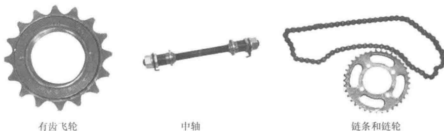
图 2-5 飞轮、中轴、链条和链轮实物结构图
