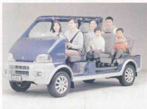
图 1-6 微型车的车身与乘客的关系剖解
