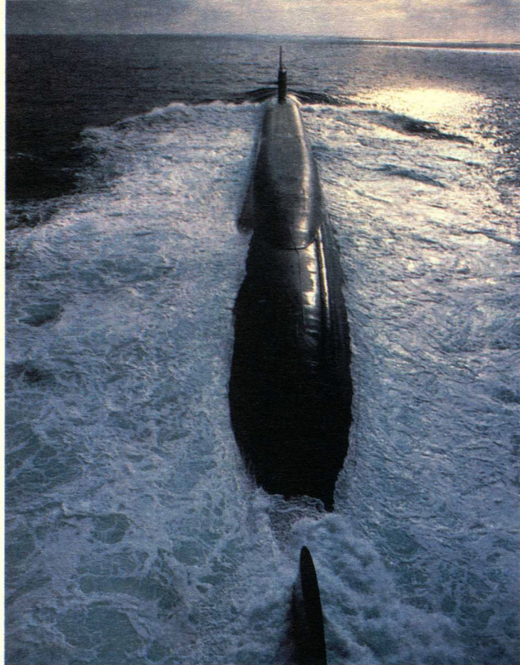
上图：作为冷战期间西方国家威力最强大的核动力弹道导弹潜艇，“俄亥俄”级最初配置了24具导弹发射管，专门用来发射“三叉戟”I型潜射弹道导弹。
