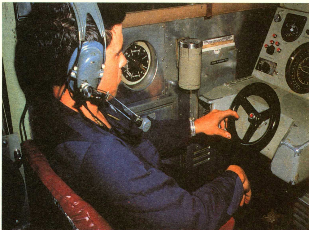
上图：美国海军“拉斐特”级核动力弹道导弹潜艇“尤利塞斯·S. 格兰特”号的声呐舱。由于核动力弹道导弹潜艇的核反应堆能够产生足够强大的电能，因此可以安装非常庞大的声呐天线。
