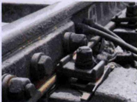
4. 绝缘轨距杆中部折断,绝缘性能失效联电引起红光带。
