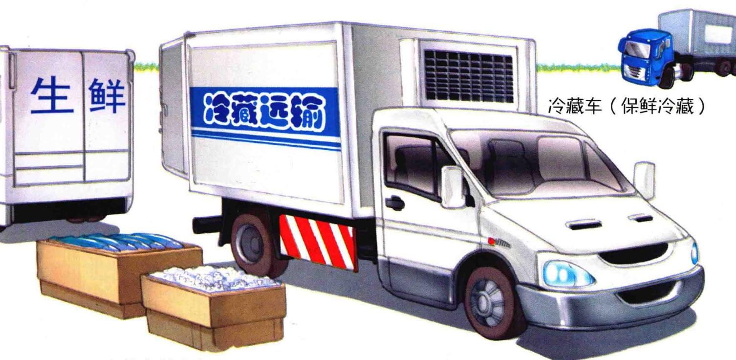
冷藏车的货柜具有很好的隔热性和密封性。冷藏车的货柜很像集装箱。
