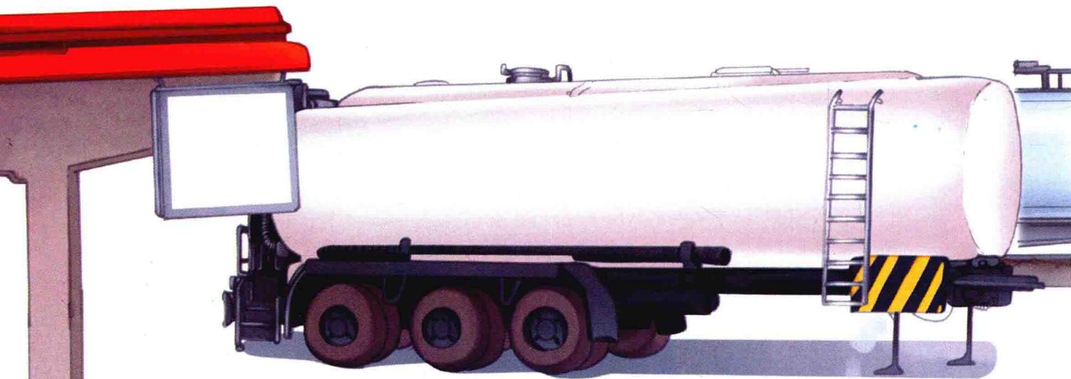
罐车的罐体是一整体筒形结构，具有良好的密封性。
