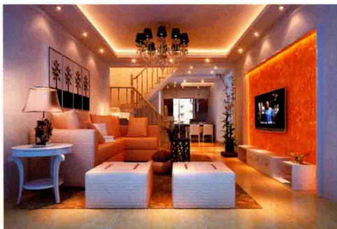
电视墙 [ 墙纸 + 石膏板造型刷白 ]
