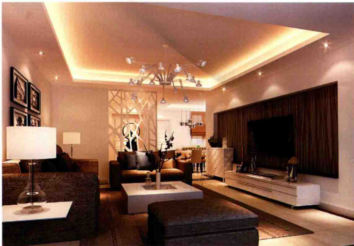
电视墙 [ 墙纸 + 石膏板造型刷白 ]
