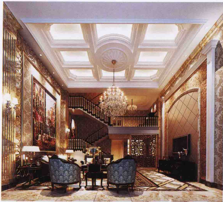
顶面 [石膏板装饰梁 + 灯带 + 石膏浮雕刷白]
