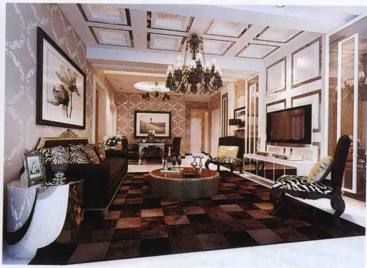
顶面 [ 木线条打方框刷白 + 黑镜装饰吊顶槽 + 银箔漆 ]
