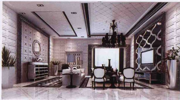
顶面 [石膏板造型拓缝 + 黑镜装饰吊顶槽]
