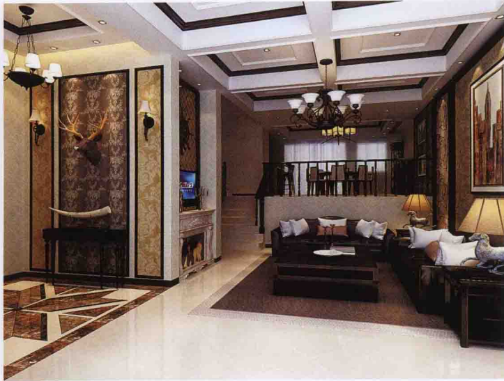
顶面 [ 石膏板装饰梁 + 木线条装饰框 ]
