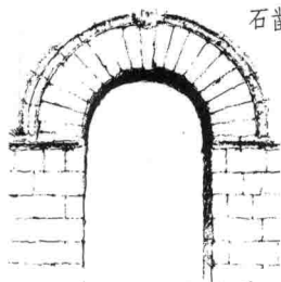
公元前 4 世纪：伊特鲁里亚人（Etruscan）发明出砖拱和砖拱顶。意大利佩鲁贾的美丽门（Porta Pulchra）。
