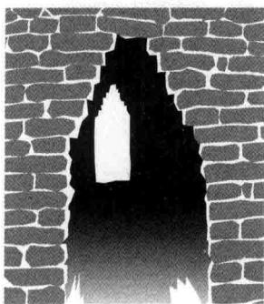
公元前 2600 年：印度河流域，哈拉帕（Harappa） 与摩亨—佐达罗（Mohenjo-daro），今巴基斯坦和 印度一带。烘烤砖块所砌的托梁拱圈。
