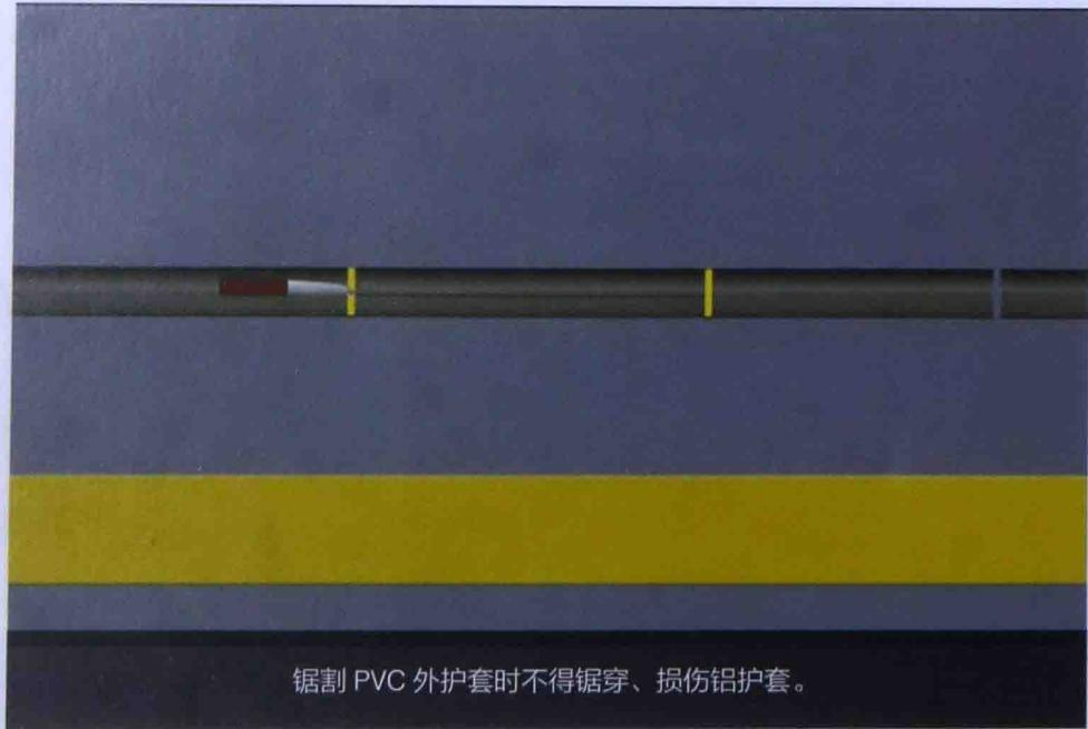
锯割 PVC 外护套时不得锯穿、损伤铝护套。
