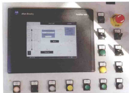
彩图50 游乐设施的触摸屏操作面板
