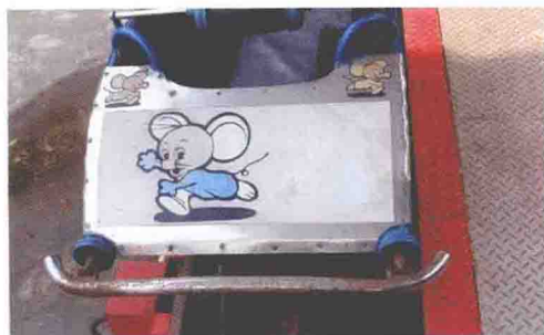
彩图59 疯狂老鼠的缓冲装置
