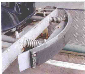
彩图58 高架自行车的缓冲装置
