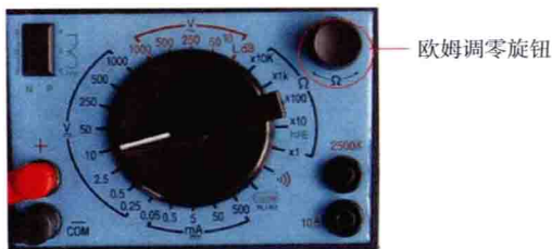
图 1-8 欧姆调零旋钮示意图
