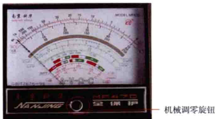
图 1-6 机械调零旋钮示意图
