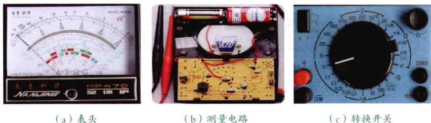
图 1-3 MF47D 型模拟式万用表的基本结构示意图
