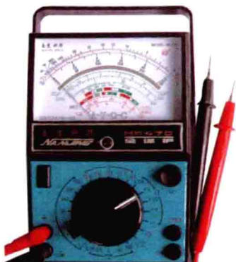
图 1-19 转换开关置于电阻挡适当的倍率挡
