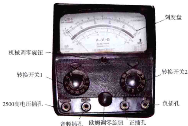
图 1-11 MF500 型模拟式万用表的面板结构示意图
