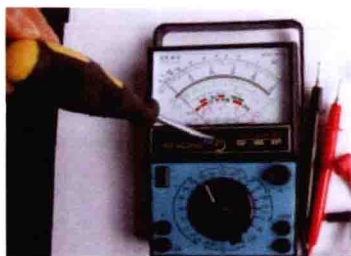
图 1-17 机械调零示意图
