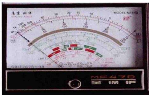
图 1-5 MF47D 型模拟式万用表的刻度盘
