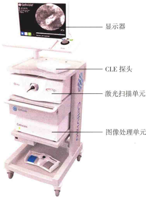
图 2-1-1 pCLE 系统的组成
