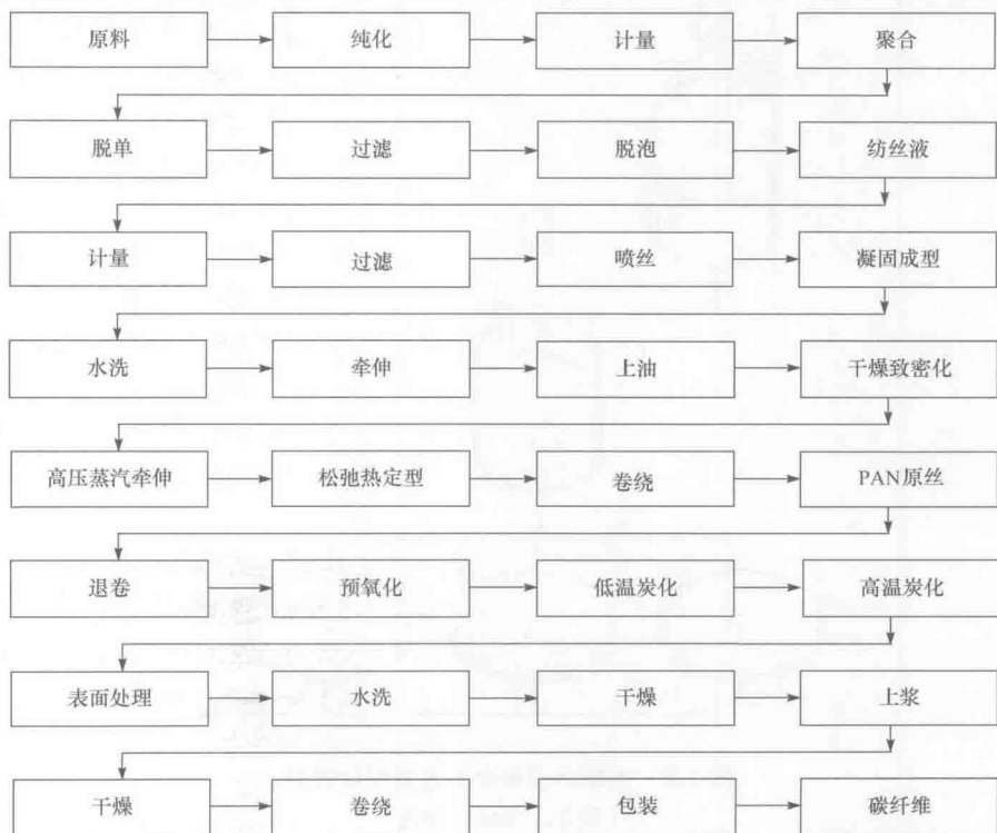
图 1.4 高性能 PAN 基碳纤维制备工艺流程
