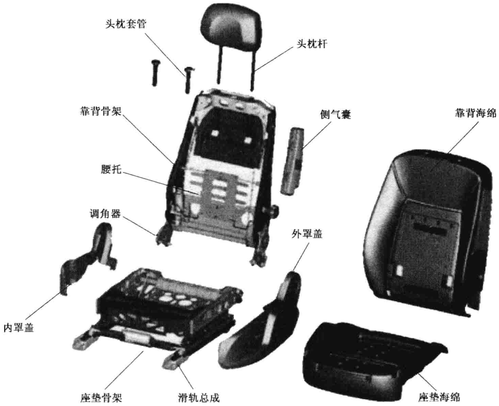
图 1-19 前排座椅结构示意图
