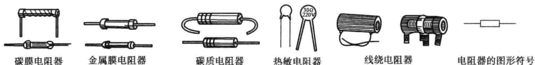
图 2-1 常用电阻器外形及图形符号
