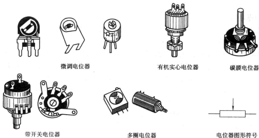
图 2-2 常用电位器的外形及图形符号
