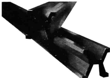
图 1.2 第一代米原器改良设计后所制作的铂铱合金米原器
