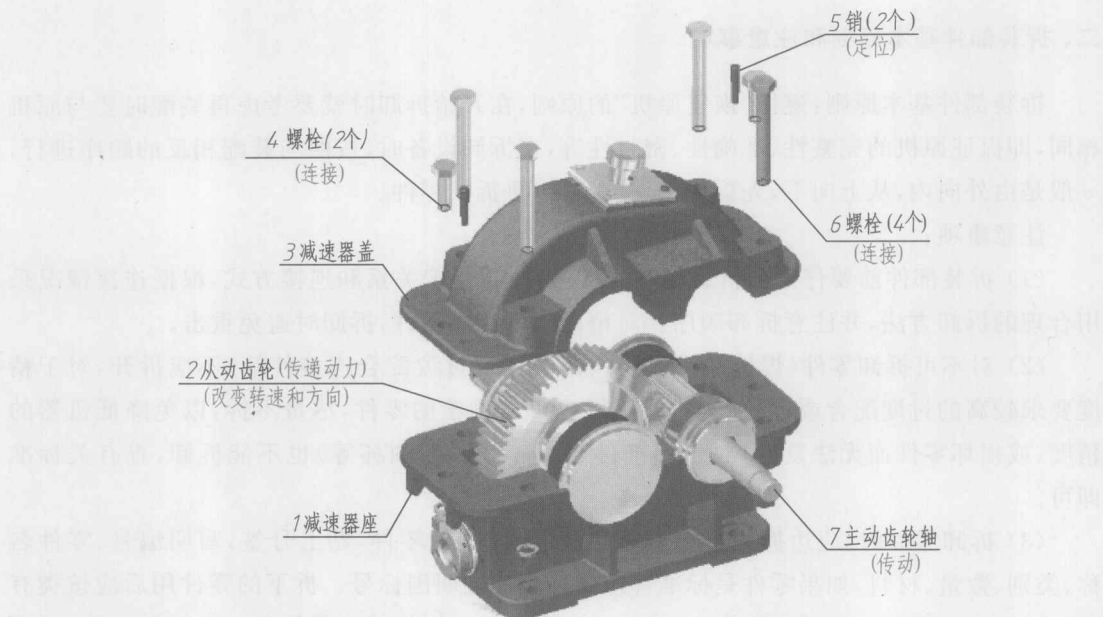
图 1-9 减速器立体爆炸图(1)
