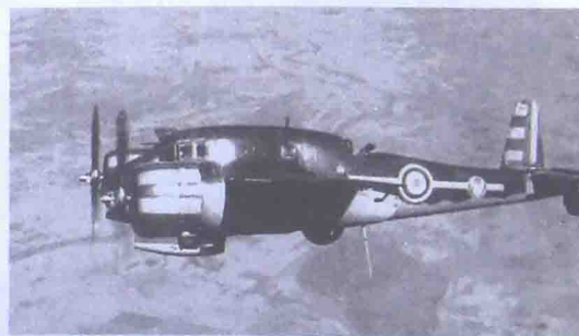
上图：布雷盖695的标志是其功率更大的惠普“双胡蜂”星形发动机。这是最后一种主要的生产型飞机，于1940年服役，总共生产了50架，并由法国空军（维希法国空军）的GBA 151联队一直使用到1942年年末。
