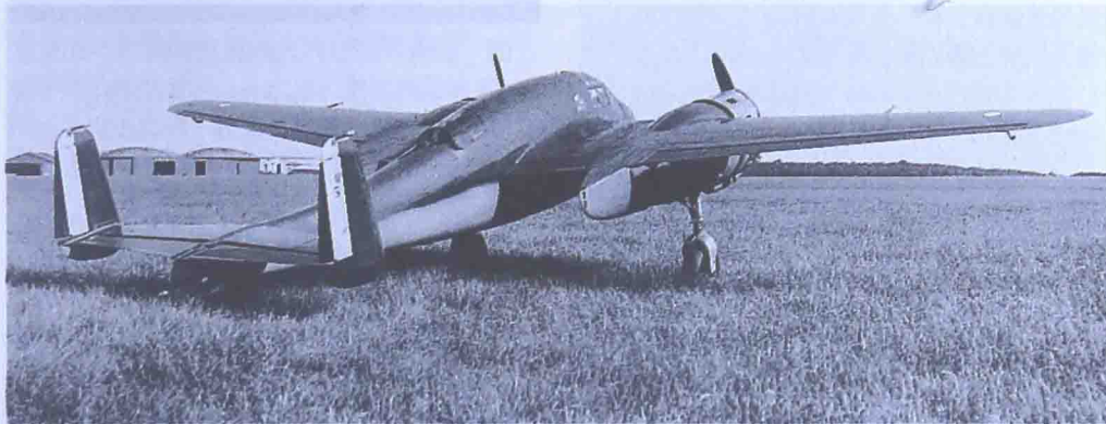
上图：干净利落而双矮胖的机身、中部安装的机翼和双尾翼，这些都是690飞机与众不同的特点。
