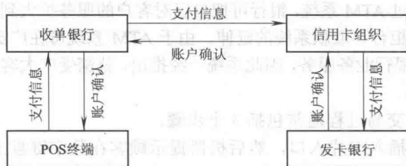
图 1-1 POS 支付流程
