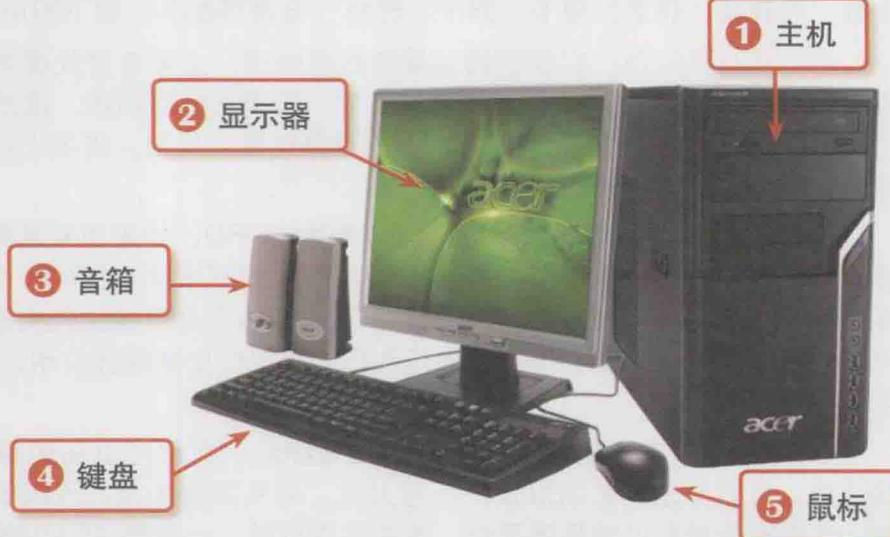
**① 主机：**是电脑工作的“发动机”，外部是机箱，内部包括CPU、主板、内存条、硬盘、显卡、声卡、光驱、电源等设备。机箱负责保护内部的这些设备，并把它们有机地组合在一起，因此应该确保选购的机箱比较结实、稳固。
