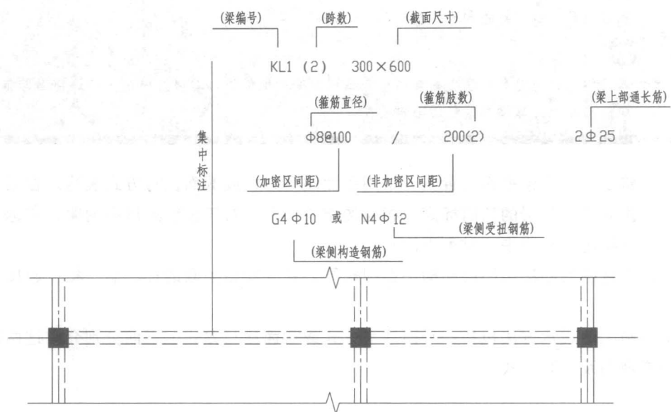
图 1-2 梁平法施工图集中标注方式示意
