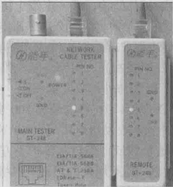
图 1-14 用测线仪测试双绞线的连接
