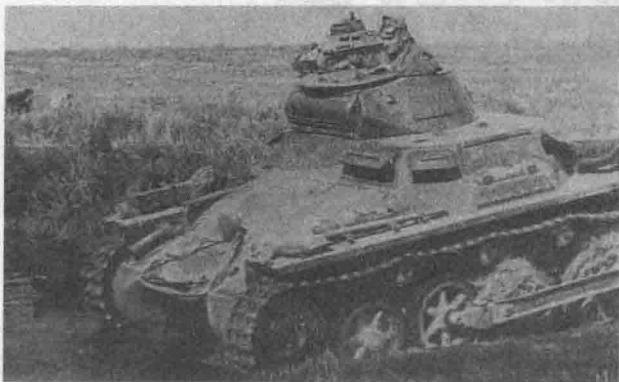
↑图为一辆一号坦克（A型）在西班牙北部越过一处积水洼地。在这张照片中可清楚看到一号坦克独特的八角形上层结构、正前方窥视窗以及小尺寸炮塔。
