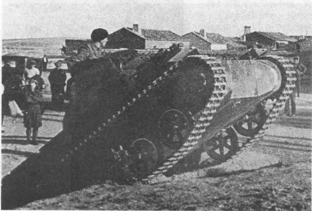
↓图为在一场演习中，一辆一号坦克登上陡峭的斜坡以展示其性能，可以清楚看到其履带和悬吊系统的灵活度。
